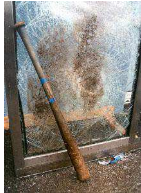
Protetto da Madico SafetyShield 1500 Certificato a Norma Antintrusione EN 356
